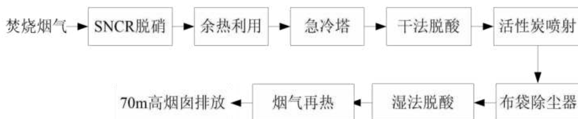
图 7.1-1 焚烧炉烟气处理工艺流程图
